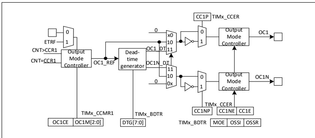
图 13-29 捕获/比较通道的输出部分(通道 1 至 3)
