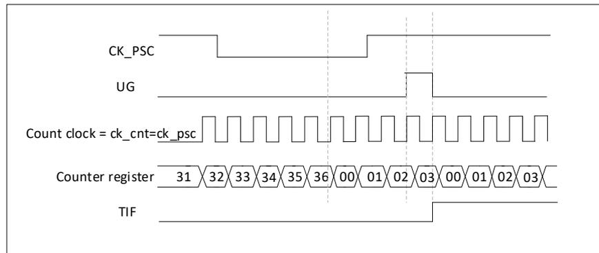
图 13-45 复位模式下的控制电路
