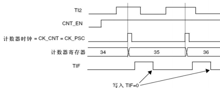
图 15-12 外部时钟模式 1 下的控制电路
