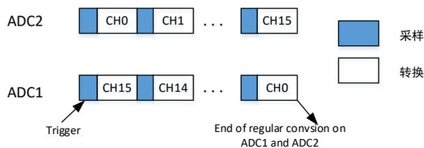
图 12-10 在 16 个通道上的同步规则模式
