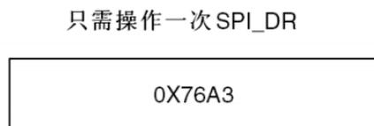
在发送时，如果 TXE 为 'E'，用户需要写入待发送的数据(即 0x76A3)。用来扩展到 32 位的 0x0000，部分由硬件首先发送出去，一旦有效数据开始从 SD 引脚送出，即发生下一次 TXE 事件。在接收时，一旦接收到有效数据(而不是 0x0000 部分)，即发生 RXNE 事件。这样，在 2 次读和写之间有更多的时间，可以防止下溢或者上溢的情况发生。
