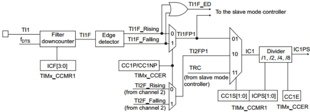
图 15-13 捕获/比较通道(如：通道 1 输入部分)
