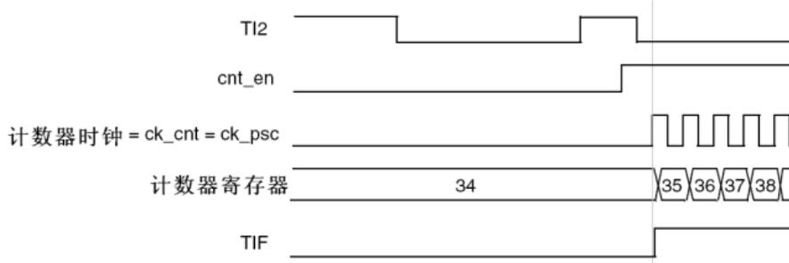
图 15-22 触发器模式下的控制电路
