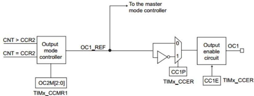
图 15-15 捕获/比较通道的输出部分(通道 1)
