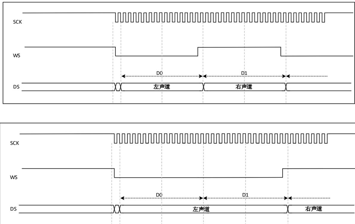
图 25-13 I2S 飞利浦协议波形(16/32 位全精度, CKPOL = 1)
