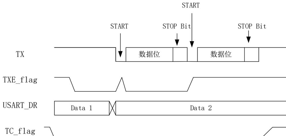
图 27-2 USART 发送时 TC/TXE 的变化
