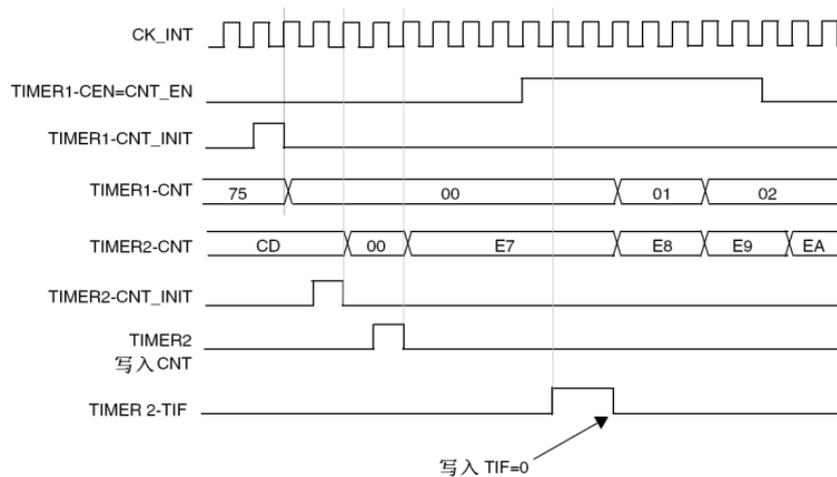
图 15-27 利用定时器 1 的使能触发定时器 2
