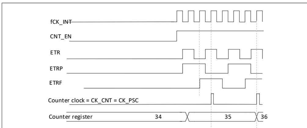
图 13-26 外部时钟模式 2 下的控制电路
