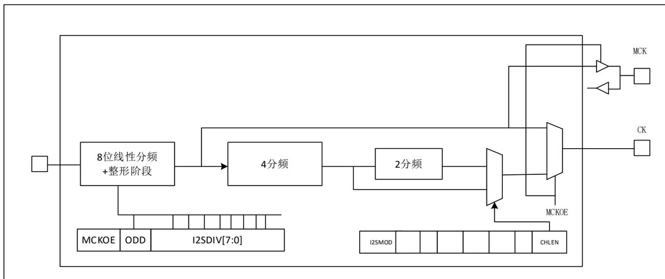
音频的采样频率可以是 96kHz、48kHz、44.1kHz、32kHz、22.05kHz、16kHz、11.025kHz 或者 8kHz(或任何此范围内的数值)。为了获得需要的频率，需按照以下公式设置线性分频器而获得，当需要生成主时钟时(寄存器 SPI\_I2SPR 的 MCKOE 位为 '为 KO :
