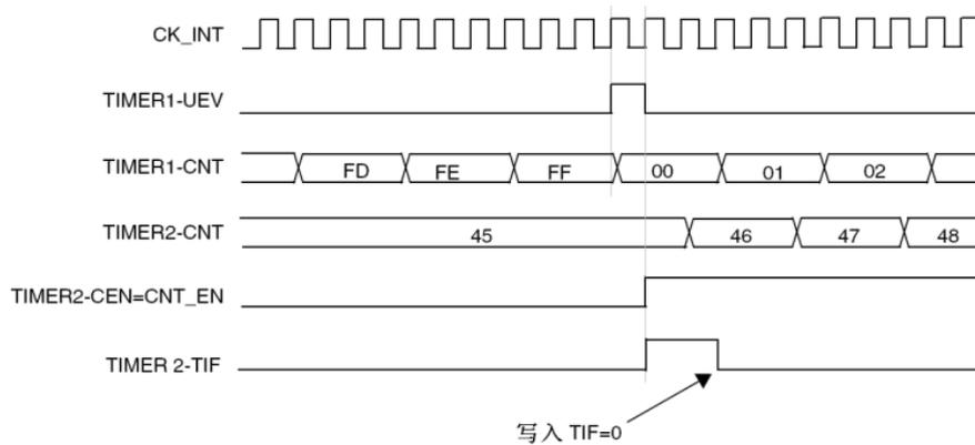
图 14-44 使用定时器 1 的更新触发定时器 2
