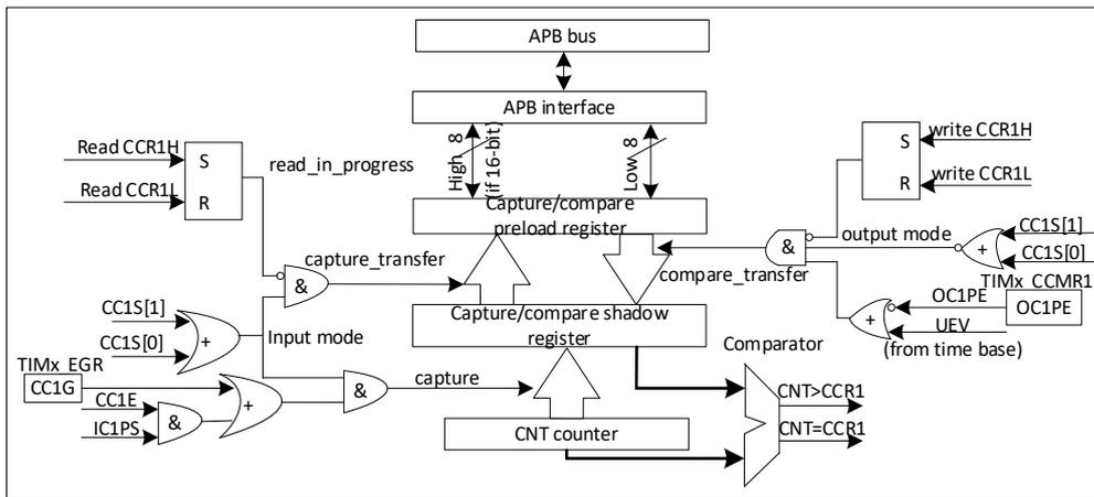
图 13-28 捕获/比较通道 1 的主电路
