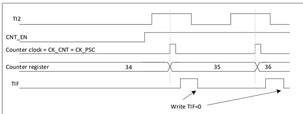
图 13-24 外部时钟模式 1 下的控制电路
