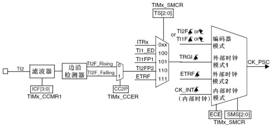
图 14-22 TI2 外部时钟连接例子
