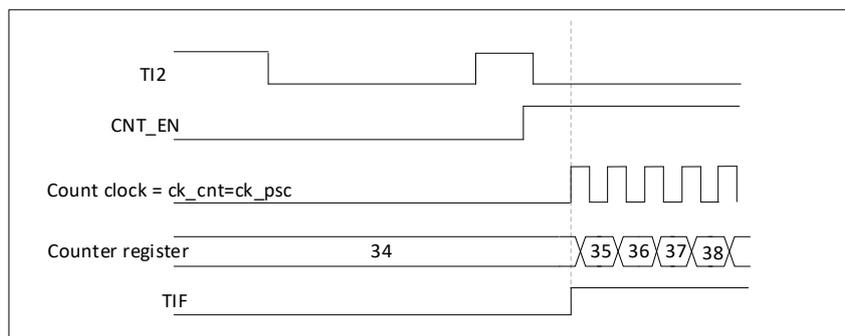
图 13-47 触发器模式下的控制电路
