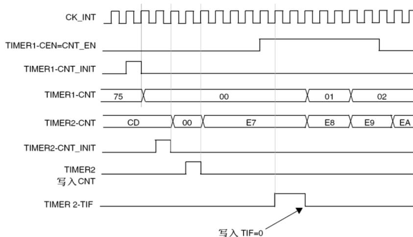
图 14-45 利用定时器 1 的使能触发定时器 2
