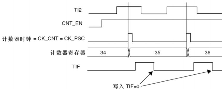
图 14-23 外部时钟模式 1 下的控制电路
