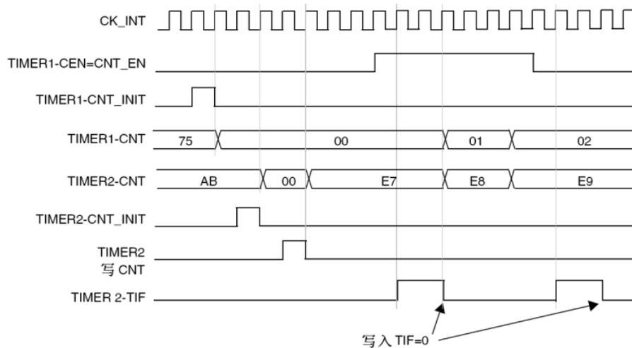
图 15-25 通过使能定时器 1 可以控制定时器 2
