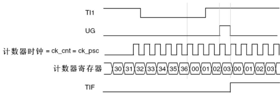
图 14-37 复位模式下的控制电路
