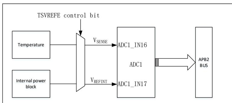
图 12-19 温度传感器通道框图
