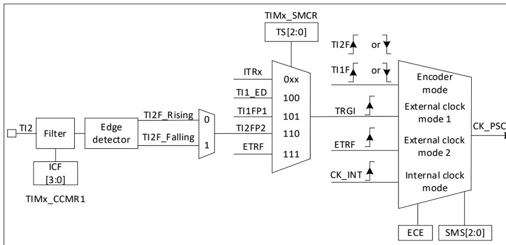
图 13-23 TI2 外部时钟连接例子
