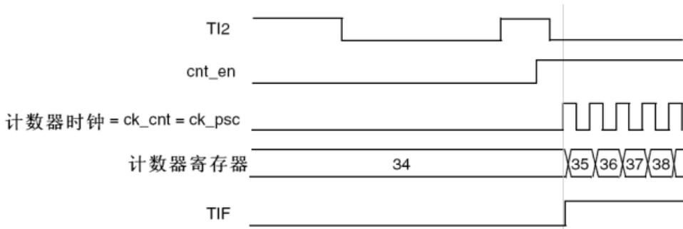
图 14-39 触发器模式下的控制电路
