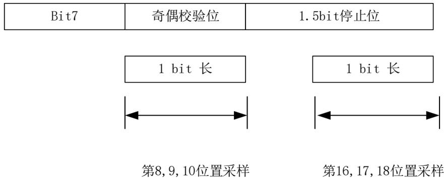
图 27-12 使用 1.5 停止位检测奇偶检验错
