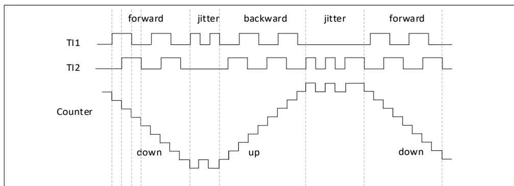
图 13-43 IC1FP1 反相的编码器接口模式实例
