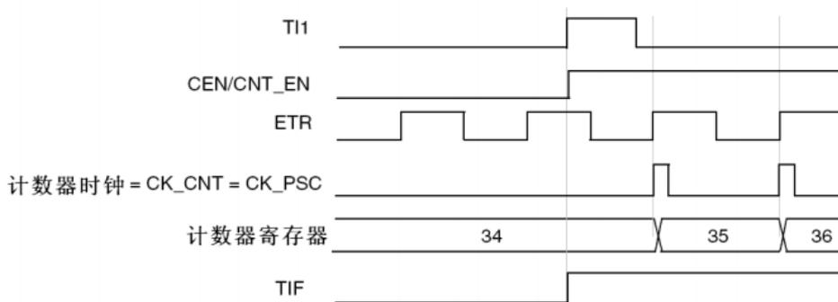
图 14-40 外部时钟模式 2 + 触发模式下的控制电路
