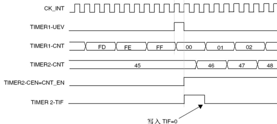
图 15-26 使用定时器 1 的更新触发定时器 2
