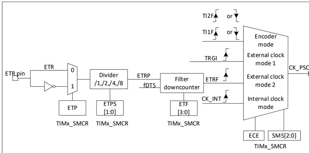
图 13-25 外部触发输入框图
