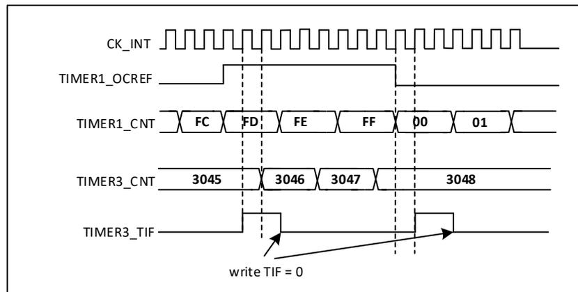
图 13-50 定时器 1 的 OC1REF 控制定时器 2
