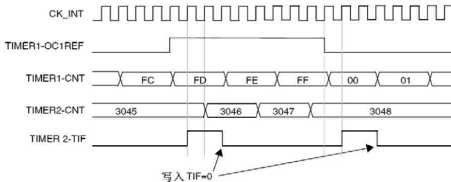
图 14-42 定时器 1 的 OC1REF 控制定时器 2
