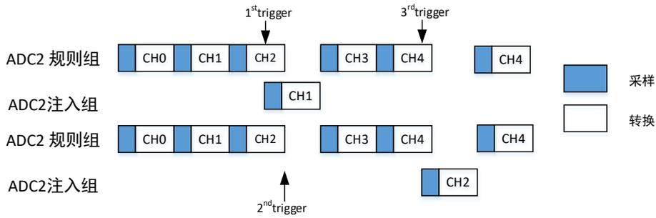
图 12-17 触发事件发生在注入转换期间
