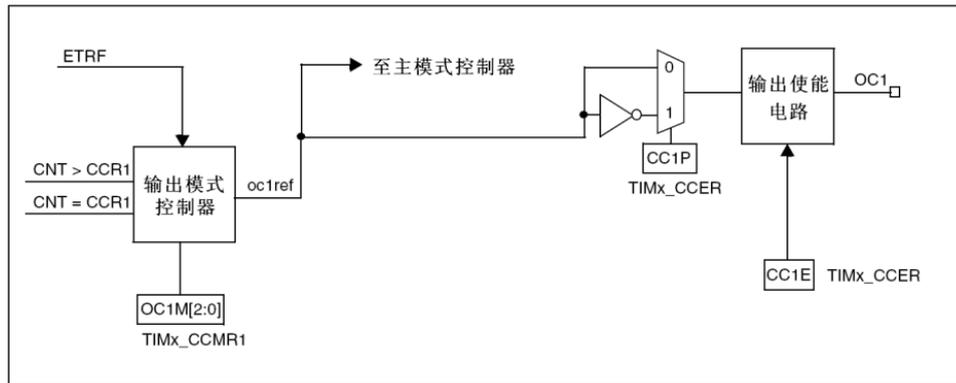
图 14-28 捕获/比较通道的输出部分(通道 1)
