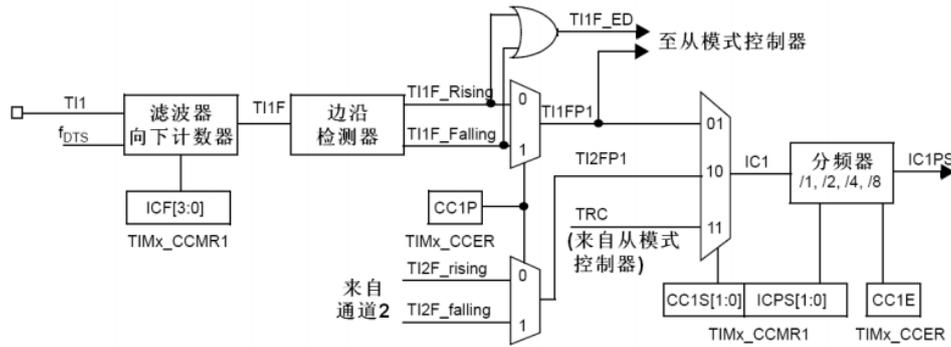
图 14-26 捕获/比较通道(如：通道 1 输入部分)
