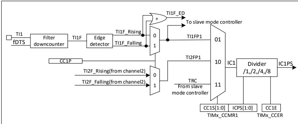
图 13-27 捕获/比较通道(如：通道 1 输入部分)
