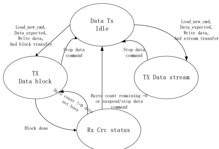
图 22-4 数据发送状态机 ( DTSM )
