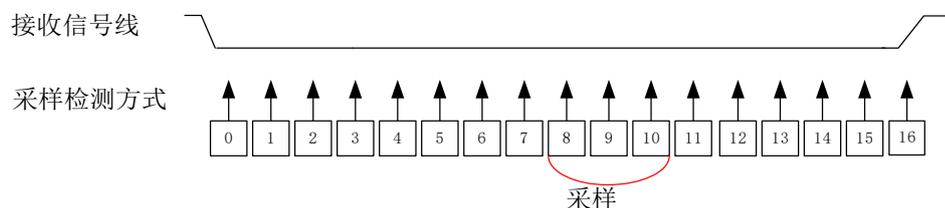
图 27-4 检测噪声的数据采样
