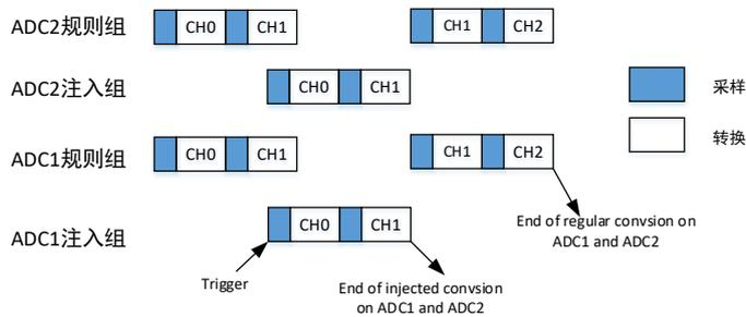
图 12-15 混合的规则/注入同步模式-scan 模式
