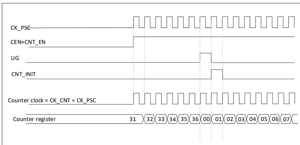
图 13-22 一般模式下的控制电路，内部时钟分频因子为 1
