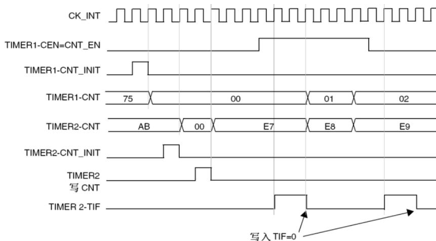
图 14-43 通过使能定时器 1 可以控制定时器 2
