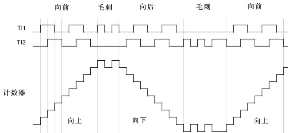
图 14-35 编码器模式下的计数器操作实例
