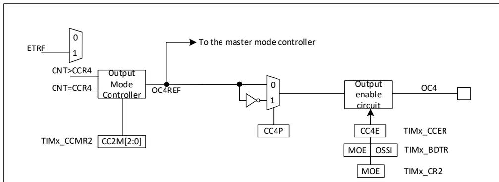
图 13-30 捕获/比较通道的输出部分(通道 4)
