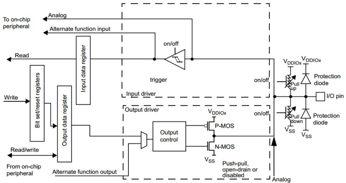
图 8-1 普通 I/O 端口位的基本结构
