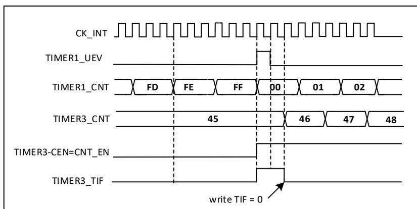
图 13-52 使用定时器 1 的更新触发定时器 2
