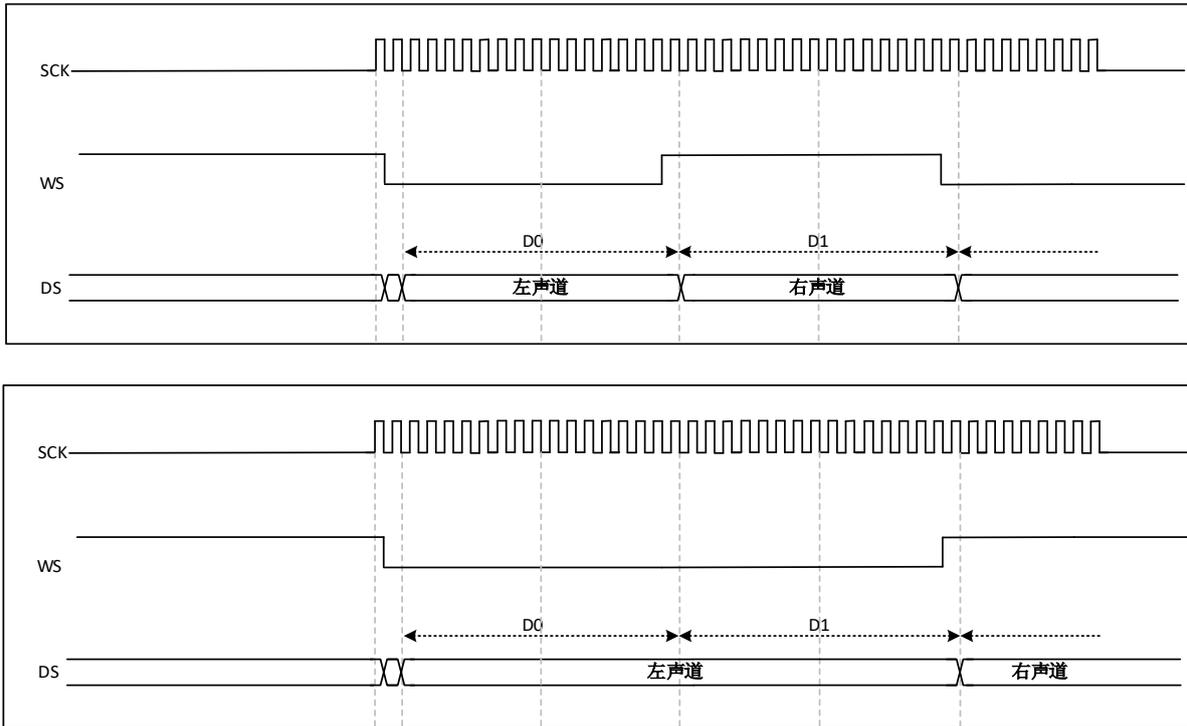
图 25-12 I2S 飞利浦协议波形(16/32 位全精度, CKPOL = 0)
