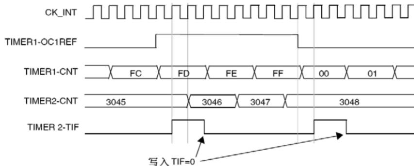
图 15-24 定时器 1 的 OC1REF 控制定时器 2
