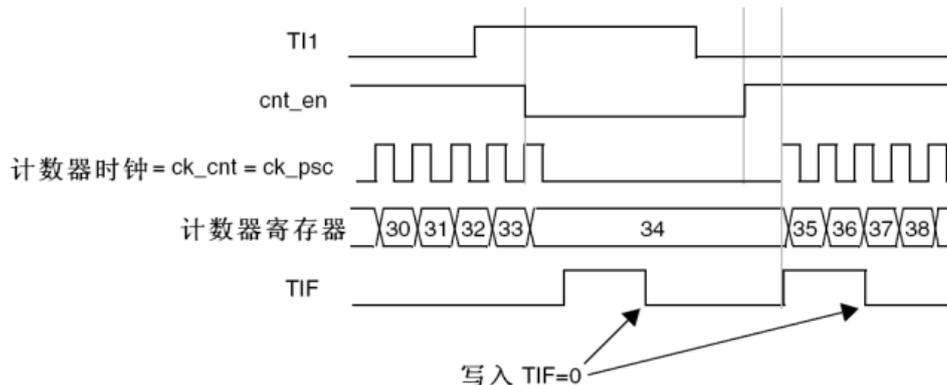
图 14-38 门控模式下的控制电路
