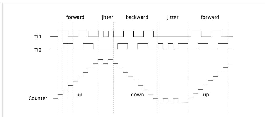
图 13-42 编码器模式下的计数器操作实例
