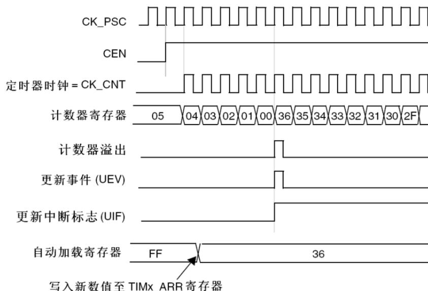
图 14-14 计数器时序图，当没有使用重复计数器时的更新事件
