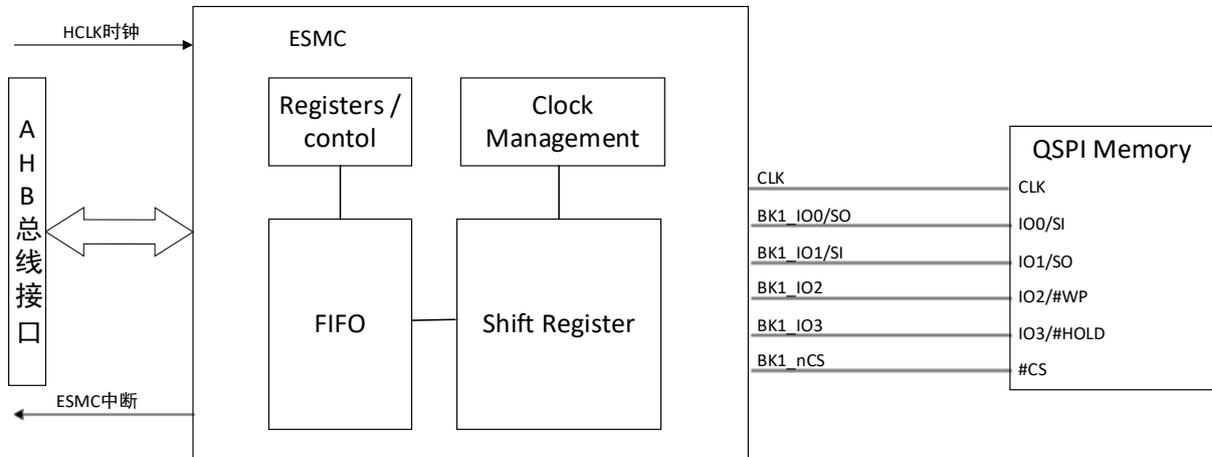
图 21-2 ESMC 连接图 ( Dual QSPI Memory 模式禁止时 )
