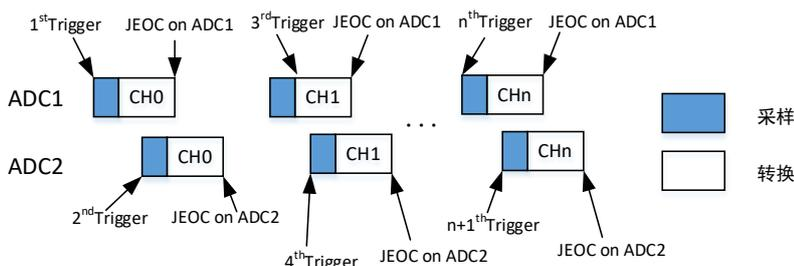
图 12-13 交替触发-每个 ADC 的注入通道组
