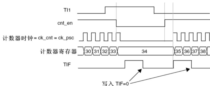
图 15-21 门控模式下的控制电路
