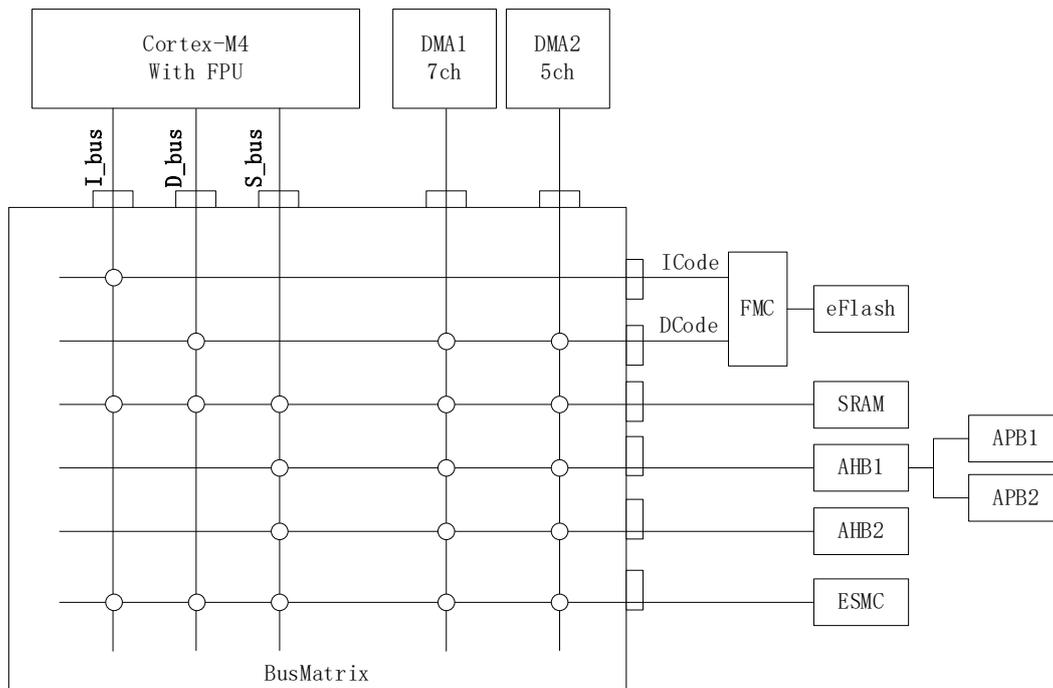
图 2-1 总线架构
