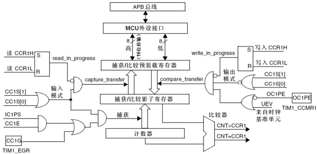
图 14-27 捕获/比较通道 1 的主电路
