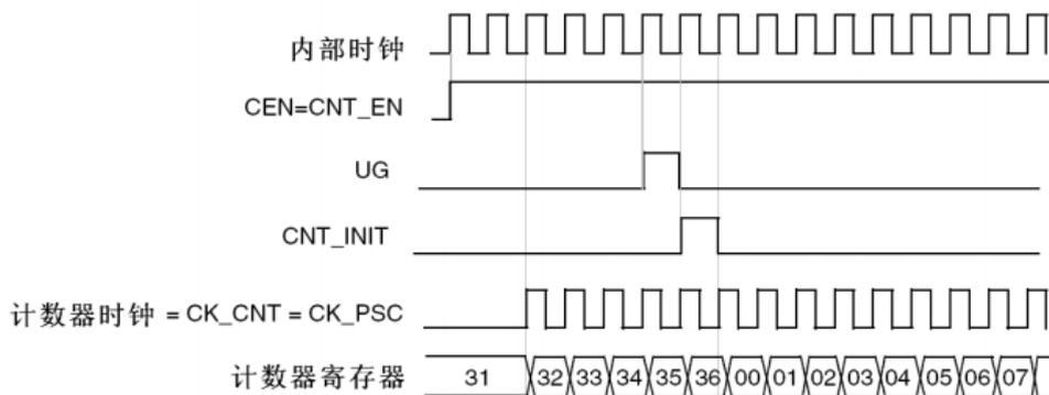
图 16-10 一般模式下的控制电路，内部时钟分频因子为 1
