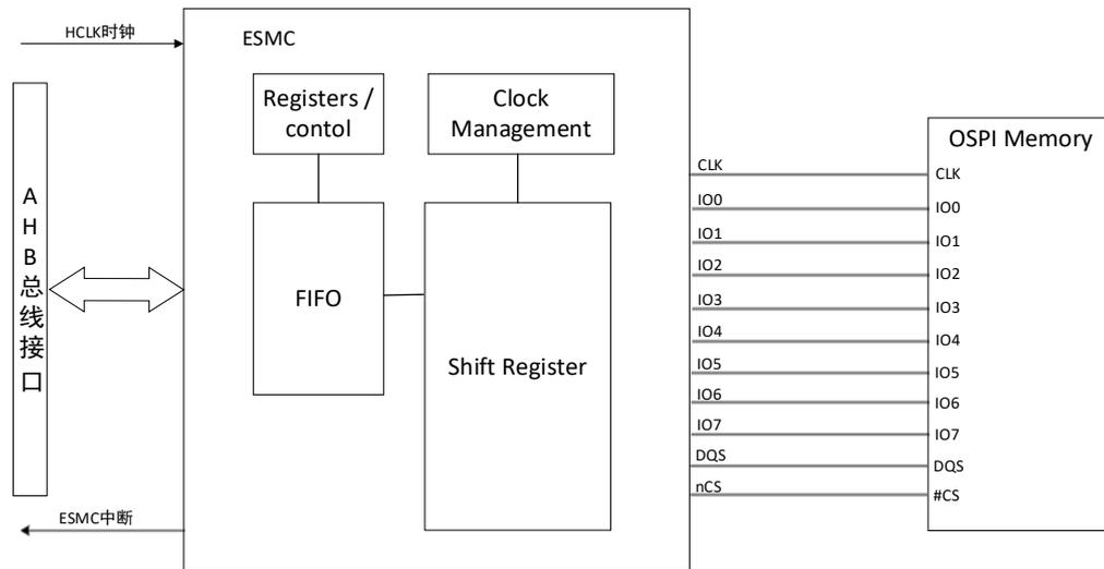
图 21-4 ESMC 连接图 ( OSPI Memory 模式设置时 )
