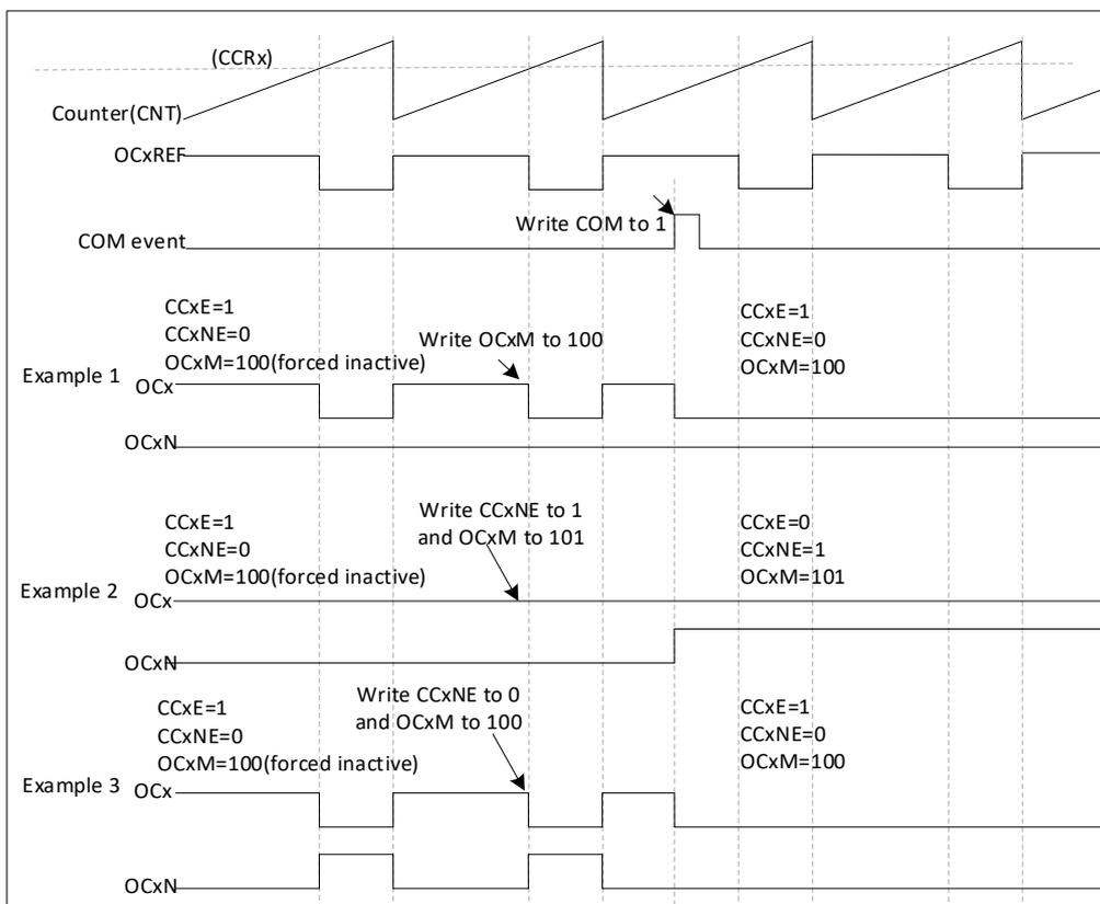
图 13-40 产生六步 PWM，使用 COM 的例子(OSSR=1)
