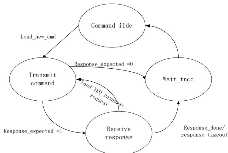
图 22-2 SD\_MMC 命令通道状态机 (CPSM)
