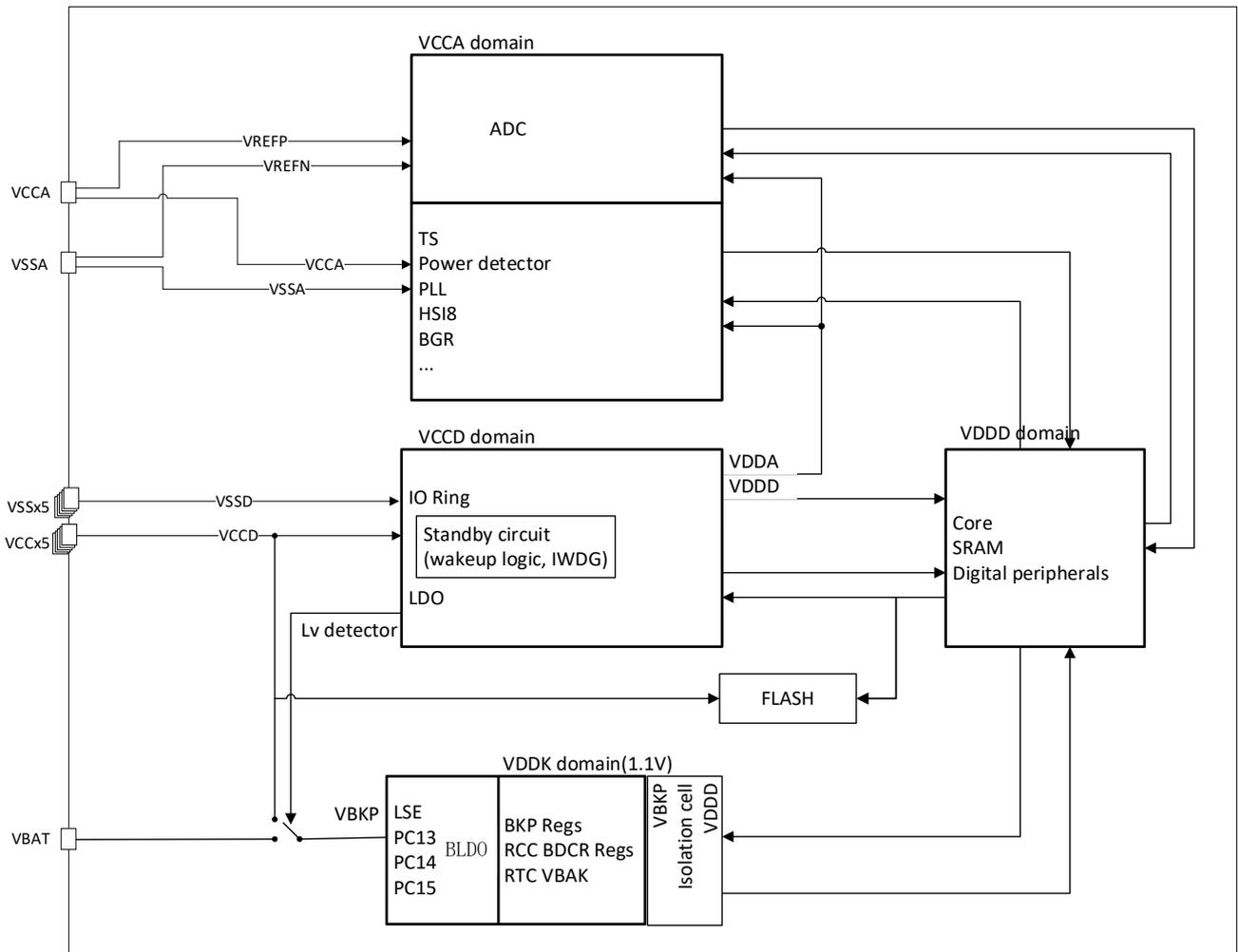
图 4-1 电源结构
