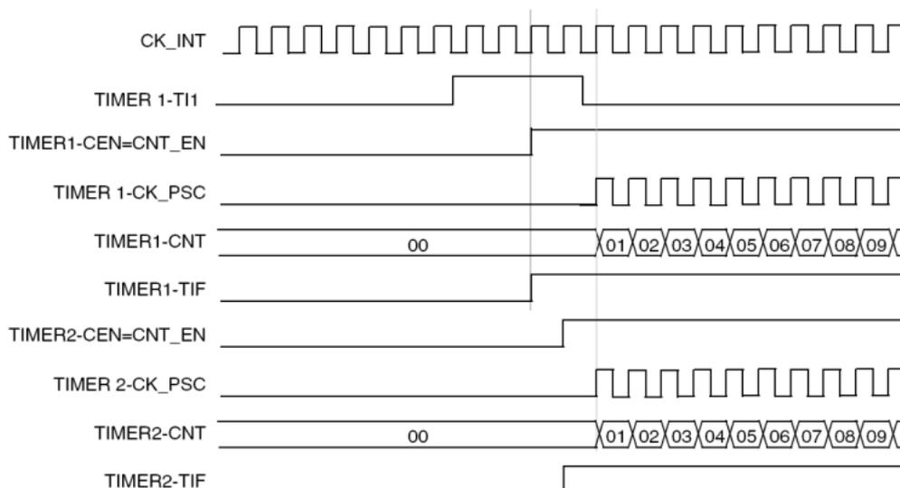
图 13-54 使用定时器 1 的 TI1 输入触发定时器 1 和定时器 2
