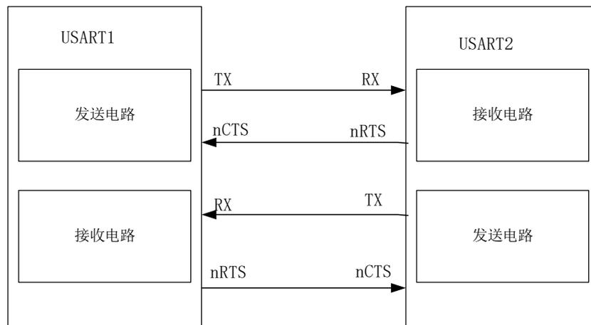
图 27-17 两个 USART 间的硬件流控制
