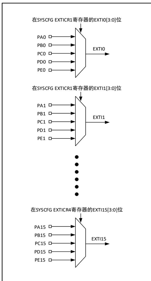
图 11-2 外部中断/事件线路映像
