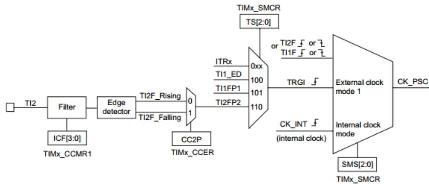
图 15-11 TI2 外部时钟连接例子
