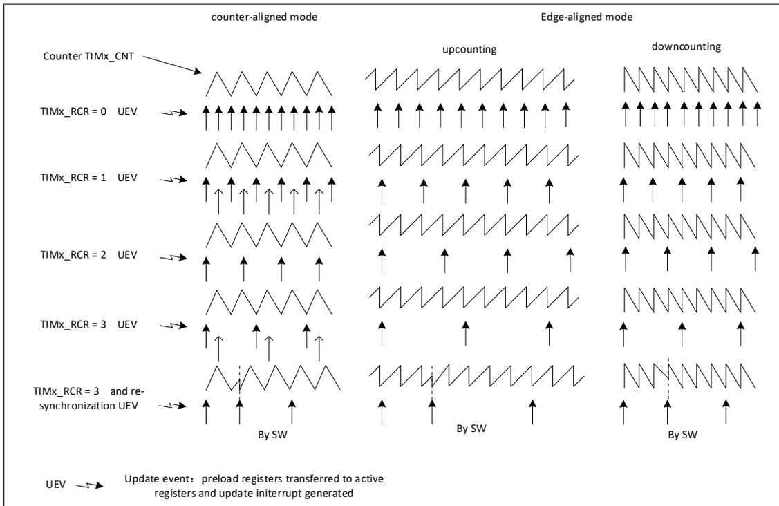
图 13-21 不同模式下更新速率的例子，及 TIMx\_RCR 的寄存器设置
