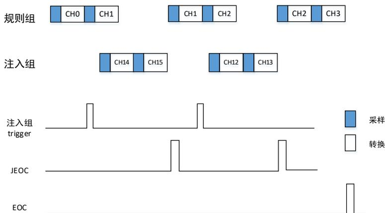
图 12-3 ADC 触发注入(扫描模式)
