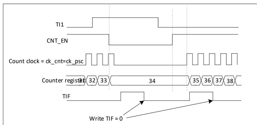
图 13-46 门控模式下的控制电路
