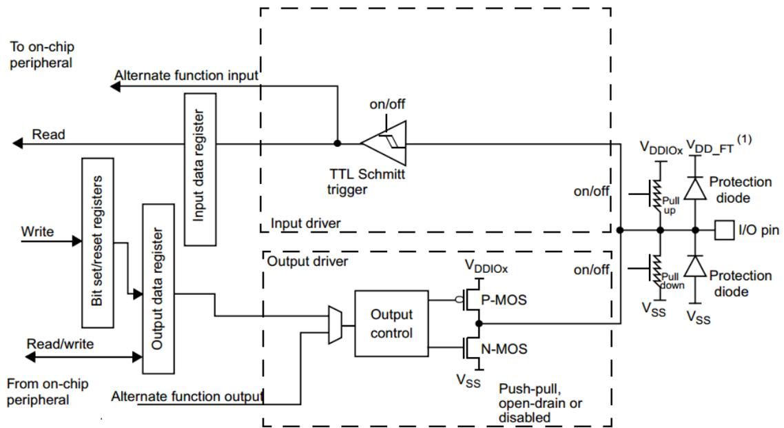
图 8-2 5V 容忍 I/O 端口位基本结构
