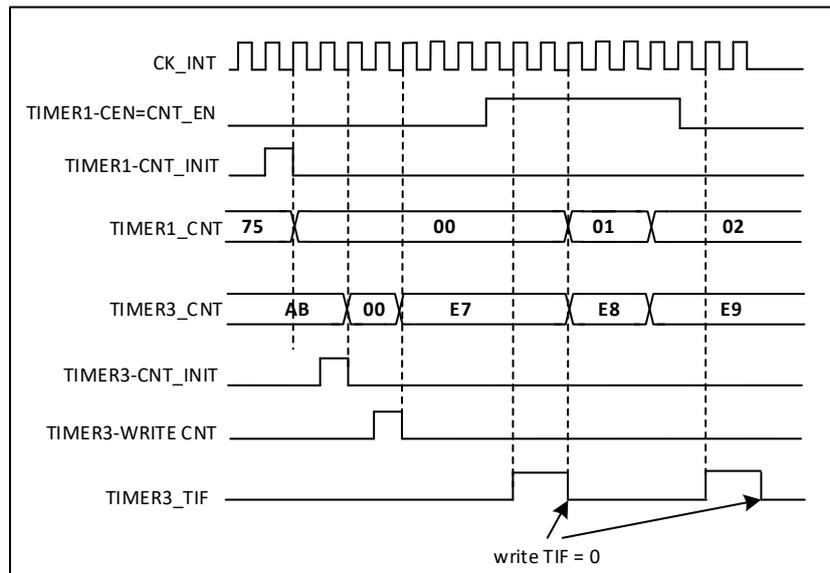
图 13-51 通过使能定时器 1 可以控制定时器 2
