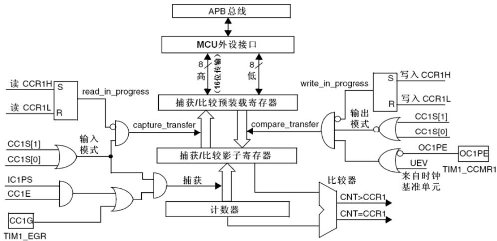
图 15-14 捕获/比较通道 1 的主电路
