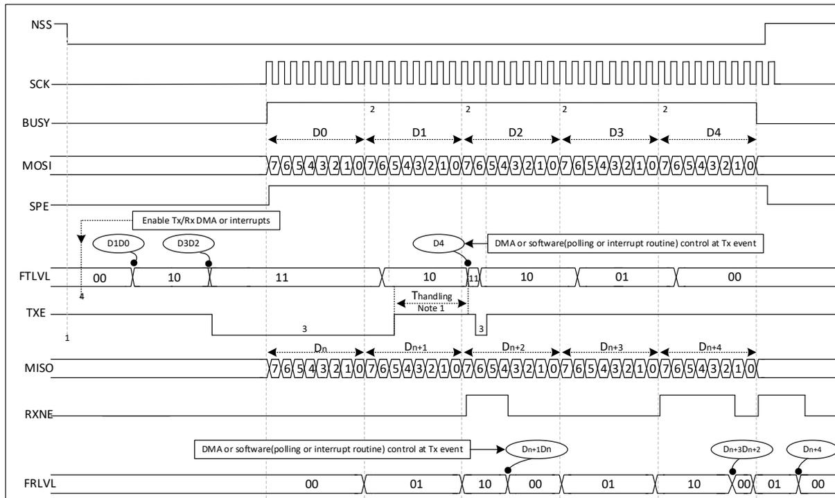
图 25-11 主机全双工通信时序图(bit frame=8)
